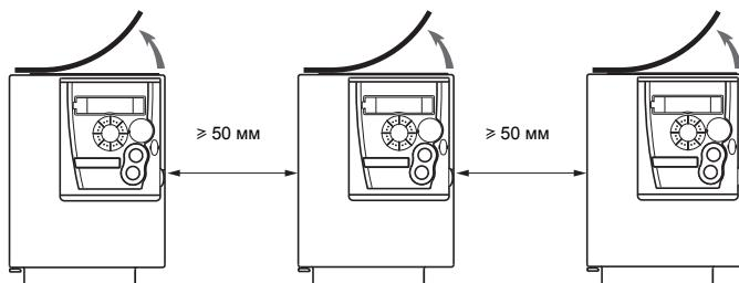
Свободное пространство  $\geq 50$  мм с каждой стороны. Для работы ПЧ при температуре окружающей среды  $> 50$  °C защитные пленки должны быть сняты. Степень защиты становится равной IP20.
