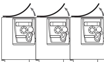
ПЧ со снятыми защитными пленками установлены вплотную друг к другу
