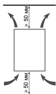
Преобразователь устанавливается в вертикальном положении  $\pm 10^\circ$ .
