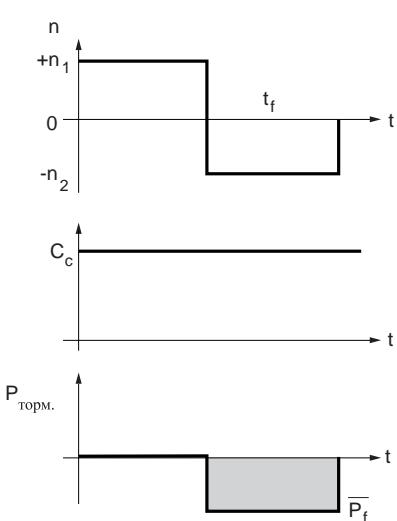
При постоянной скорости мощность торможения остается постоянной в течение всего времени торможения.
