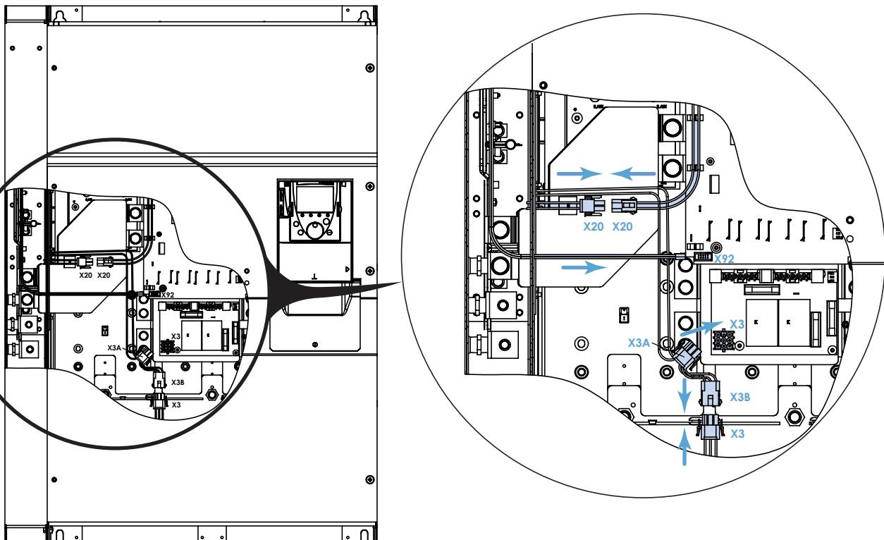
8 Закрепите на стене или задней стенке шкафа шасси дросселя постоянного тока (С). См. рекомендации, приведенные в Руководстве по установке преобразователя
