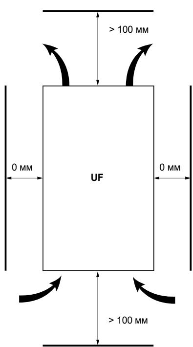
Тормозной модуль устанавливается в вертикальном положении. Подключение тормозного модуля осуществляется снизу. При правильном подключении тормозной модуль отвечает степени защиты IP20.
