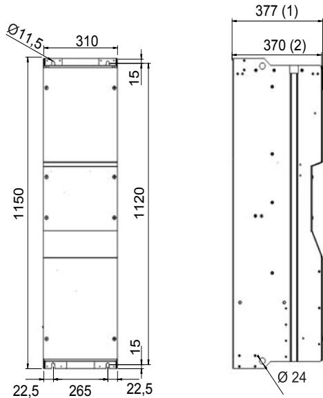
(1) Наличие тормозного модуля VW3 A7 101 не изменяет глубины комплекта: преобразователь + тормозной модуль.
