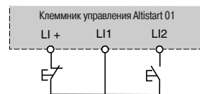
Схема 3-проводного управления
