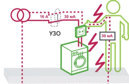
Измеряя разность силы тока между проводником под напряжением и нулевым проводником, дифференциальный выключатель нагрузки фактически обнаруживает ток, протекающий через тело человека.
