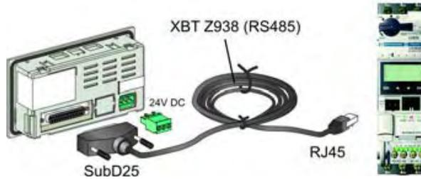
Для подключения вашего терминала ХВТ к другому ПЛК или отводу полевой шины см. список ниже, где перечислены соответствующие разным случаям кабели.
